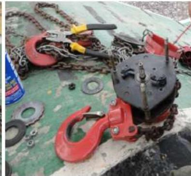
Mantenimiento general del tecla (limpeza del cuerpo, fibras de freno, lubricación del giro del gancho de anclaje y de carga)
