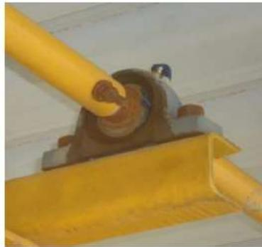
Se engrasa los rodamientos del eje de transmisión
