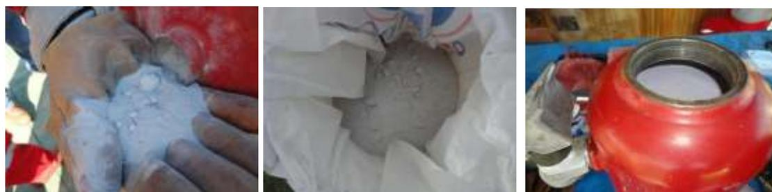
*Verificación estado, tamizado y llenado del polvo PQS a extintores.*
