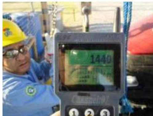
*Prueba de Carga en tecles Área Sala de Combustible, Generadores y C. de Aire.*
