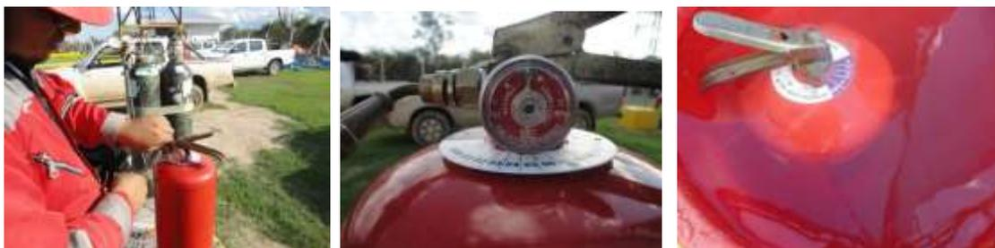
*Presurizado de Extintores y prueba de fuga en sumerción de agua a extintores.*
