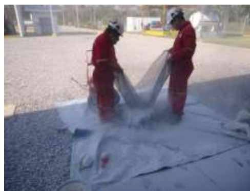
Mantenimiento de Extintores Portátiles y Rodantes. Vaciado y tamizado de PQS.
