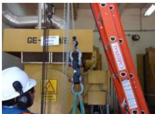
Se realizó prueba de carga a líneas de vida
