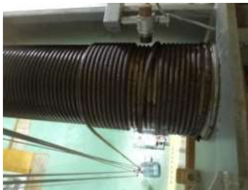
Inspección y Mantenimiento panel Eléctrico, y estado de cables y poleas, en puentes Grúas Cap. 17 TN. Sala T.C.
