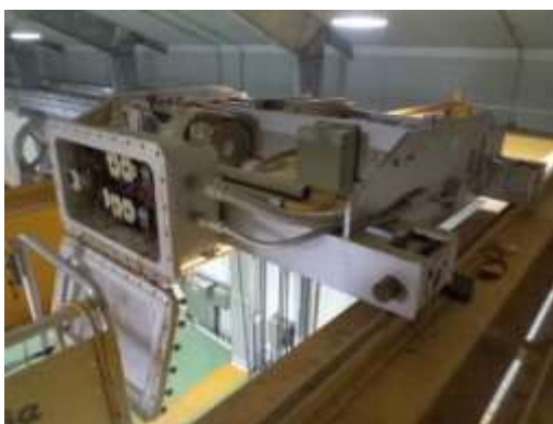
Inspección y Mantenimiento panel Eléctrico, y estado de cables y poleas, en puentes Grúas Cap. 17 TN. Sala T.C.
