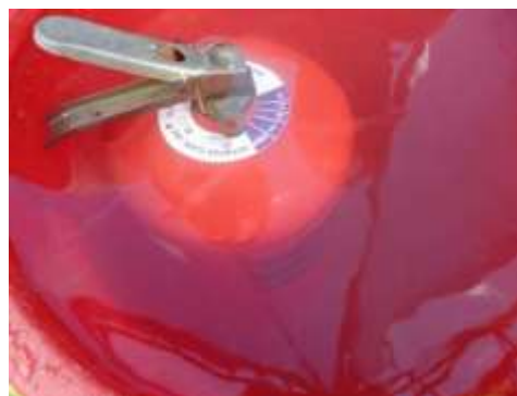
PH. de Extintores y prueba de fuga en sumerción de agua a extintores.
