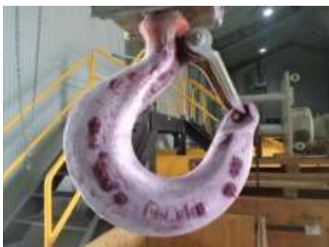
Inspección, verificación y mantenimiento de partes de tecles y puentes, prueba de tinta penetrante a ganchos
