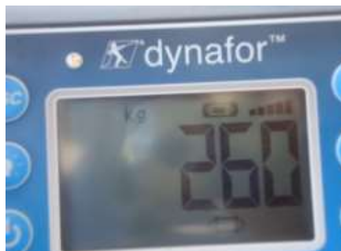
Se realizó prueba de carga a líneas de vida
