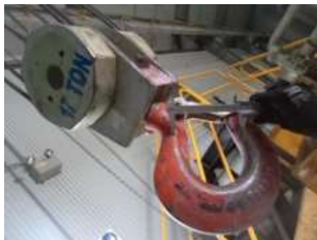
Inspección, verificación y mantenimiento de partes de tecles y puentes, prueba de tinta penetrante a ganchos
