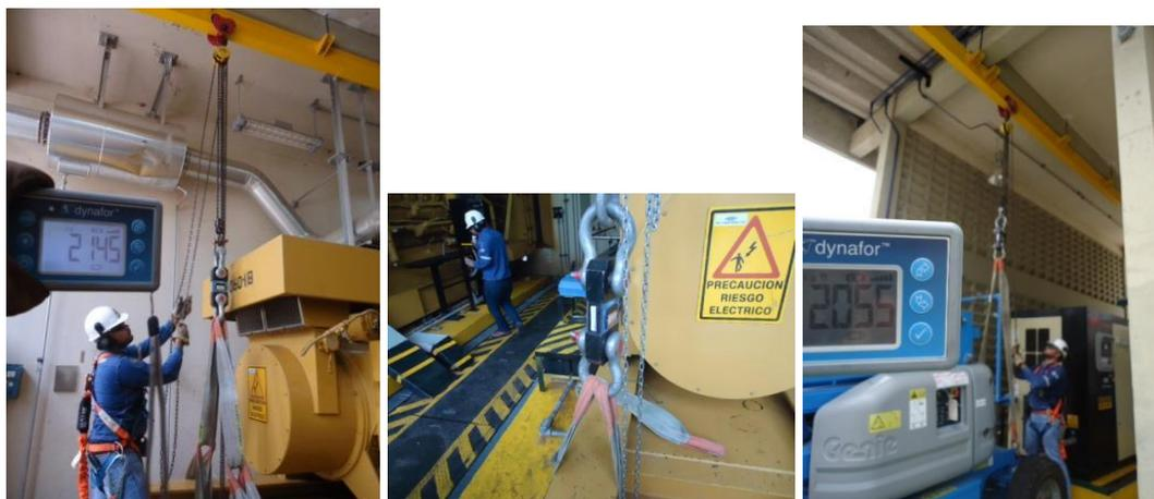
*Prueba de carga a 4 vigas carrileras peso probado 2,1 TN*
