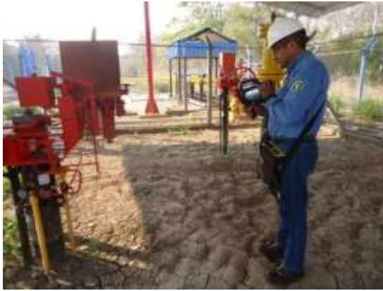
Medición de fugas de gas en los corralitos de válvulas y termo generadores.
